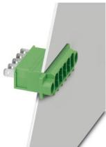
穿墙式插座，额定横截面: 4 mm<sup>2</sup>，颜色: 绿色，额定电流: 15 A，额定电压(III/2): 400 V，触点表面: Sn，触点类型: 针式插头，电位数: 9，行数: 1，位数: 9，连接量: 9，产品系列: DFK-PC 4/-G-FS4,8，针距: 7.62 mm，接线方式: 滑插连接技术，安装: 直接安装，每个电势的焊针数量: 1，插拔系统: COMBICON PC 4，针式连接器样式对齐: 标准，互锁: 不带，安装方式: 不带，包装类型: 纸箱包装
