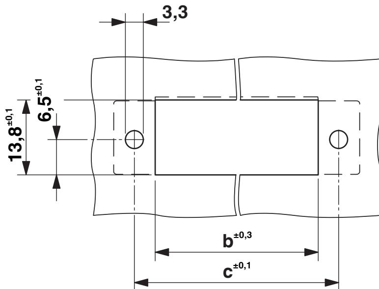
尺寸  $b = 68.53 \text{ mm}$ ; 尺寸  $c = 76.20 \text{ mm}$
