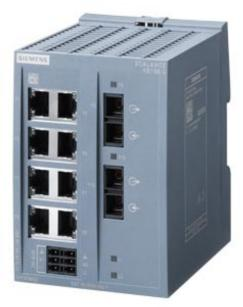
SCALANCE XB108-2 unmanaged IE Switch, 8x 10/100 Mbit/s Ports, 2x 100 Mbit/s Multimode SC, zum Aufbau von kleinen Stern- und Linienstrukturen; LED-Diagnose,IP20, redundante Spannungsversorgung, AC/DC 24V Handbuch als Download verfügbar
