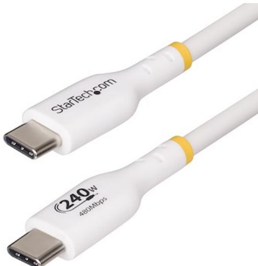
Conecte un cargador a un dispositivo USB Power Delivery (PD) 3.1, utilizando este cable de carga USB-C. El cable USB-C facilita hasta 240W de suministro de energía USB-C Extended Power Range (EPR) y una salida de 5A para una carga rápida. Es compatible con el rendimiento USB 2.0 (480 Mbps) para la transferencia de ficheros en general.
