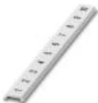
Zackband flach, Streifen, weiß, beschriftet, längs bedruckt: fortlaufende Zahlen 1 ... 10, 11 ... 20 usw. bis 91 ... 100, Montageart: verrasten in flacher Schildchennut, für Klemmenbreite: 6,2 mm, Schriftfeldgröße: 5,15 x 6,15 mm
