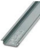
Tragschiene ungelocht, Standardprofil, Breite: 35 mm, Höhe: 7,5 mm, nach EN 60715, Material: Aluminium, unbeschichtet, Länge: 2000 mm, Farbe: silberfarben
