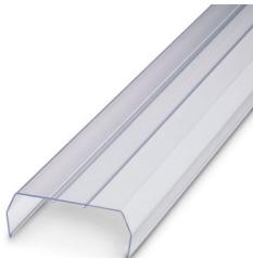
保护盖罩，用于端子条的遮盖保护，卡接至APT-ME盖罩支架或APH-ME终端紧固件。将盖罩支架安装在端子条末端，每隔40 cm左右安装一个支架。供货长度：1 m
