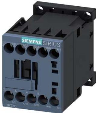
Leistungsschütz, AC-3e/AC-3, 7 A, 3 kW / 400 V, 3-polig, DC 24 V, mit integrierter Diode, Hilfskontakte: 1 S, Schraubanschluss, Baugröße: S00
