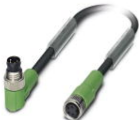
センサ/アクチュエータケーブル, 4-極, PUR ハロゲンフリー, 黒-灰RAL 7021, プラグ アングル M8, 上 ソケット ストレート M8, ケーブル長: 1.5 m
