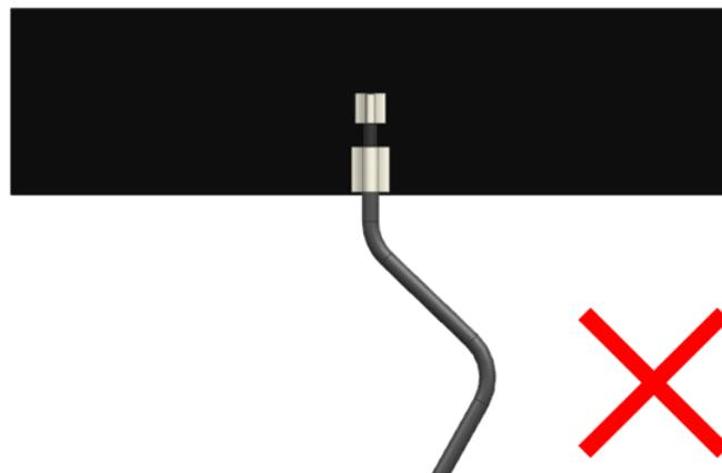
**FIGURE 5.2.3 MULTIPLE BENDING OF CABLES IS NOT RECOMMENDED**
