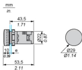
e : épaisseur du dispositif de serrage : 1 mm à 6 mm / 0,03 pouce à 0,24 pouce
