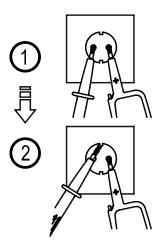
为了避免 RCD 跳闸,必须在 L 和 N 之间进行约 5 秒钟的测试。随后可立即在 L 和 PE 之间进行电压测试而不会发生 RCD 跳闸。
