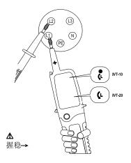
▲ 在中性线缆接地的情况下,可使用 100V 交 流电压执行相序方向测试(相至相)。
