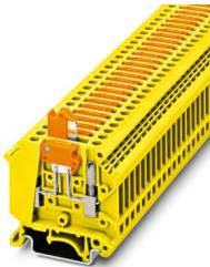
刀闸分断接线端子，带测试插座螺栓，用于插入测试插头，标称工作电压: 500 V，额定电流: 16 A，第一层，接线方式: 螺钉连接，额定接线容量: 2.5 mm<sup>2</sup>，接线容量：0.2 mm<sup>2</sup> - 6 mm<sup>2</sup>，安装: NS 32，NS 35/7.5，NS 35/15，颜色: 黄色
