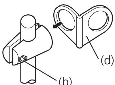
Befestigen Sie den Haltewinkel (d) und ziehen Sie anschließend die Schraube (b) soweit an, daß sich der Winkel noch drehen läßt.
