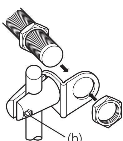
Ziehen Sie nach Montage und Ausrichtung des Sensors die Schraube (b) fest.
