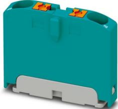
单模块，底座端子，标称工作电压: 450 V，额定电流: 24 A，连接量: 2，接线方式: 直插式连接，横截面: 0.14 mm<sup>2</sup> - 4 mm<sup>2</sup>，安装方式: 用于卡接在DIN导轨适配器上，直接安装，带法兰，自由悬挂，颜色: 青绿色
