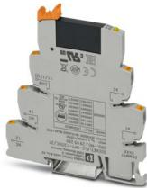
PLC-INTERFACE, bestehend aus Grundklemme PLC-BPT.../21 mit Push-in-Anschluss und steckbarem Miniatur-Solid-State-Relais, zur Montage auf Tragschiene NS 35/7,5, 1 Schließer, Eingang: 120 V AC/110 V DC, Ausgang: 3-48 V DC/100 mA
