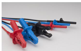
**Clasificación del aislamiento de los cables:** 12 kV cc (marcado en el cable)
