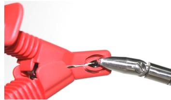
Pinza de Megger durante una comprobación con dedo de prueba de acuerdo con la norma IEC para determinar la distancia de fuga y holgura.
