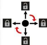
Para bloquear, coloque las flechas en la protección para los dedos del enchufe en posición horizontal en el instrumento como se muestra. Gire a 90° para desbloquear. Además, por la misma razón, las pinzas de prueba no se pueden desmontar del cable de prueba.
