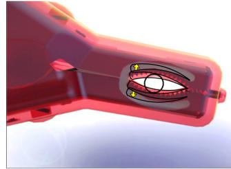
Los dedos móviles de la mordaza mantienen la seguridad de las pinzas a prueba de contacto cuando la pinza está cerrada, pero se retraen para permitir que los dientes metálicos de la pinza entren en contacto libremente con la pieza de prueba cuando está en uso.
