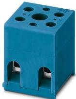
设备接线端子，带集成二极管，标称工作电压: 500 V，额定电流: 32 A，连接量: 4，接线方式: 螺钉连接，横截面: 0.2 mm<sup>2</sup> - 4 mm<sup>2</sup>，安装方式: 直接螺钉连接，颜色: 蓝色
