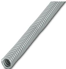
Schutzschlauch, Material: PVC, Wendel: PVC ummantelter Federstahl, UV-beständig: nein, flexibel, Schutzart: IP68, Farbe: grau, Innendurchmesser: 16 mm, Gesamtlänge: 10 m
