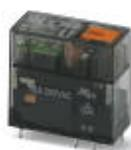
Relé miniatura enchufable, con contacto de potencia, 1 contacto conmutado, tecla de comprobación, indicación mecánica de la posición de conmutación, LED de estado, tensión de entrada 230 V AC
