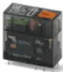
Relés miniatura enchufables, con contacto multicapa con capa de dorado duro, 2 contactos conmutados, tecla de comprobación, indicación mecánica de la posición de conmutación, LED de estado, tensión de bobina 230 V AC
