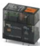
Relés miniatura enchufables, con contacto multicapa con capa de dorado duro, 1 contacto conmutado, tecla de comprobación, indicación mecánica de la posición de conmutación, LED de estado, tensión de entrada 230 V AC
