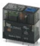
Relés miniatura enchufables, con contacto multicapa con capa de dorado duro, 1 contacto conmutado, tecla de comprobación, indicación mecánica de la posición de conmutación, LED de estado, diodo de libre circulación, polaridad A1+, A2-, tensión de entrada 24 V AC
