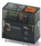
Relé miniatura enchufable, con contacto de potencia, 2 contactos conmutados, tecla de comprobación, indicación mecánica de la posición de conmutación, LED de estado, tensión de bobina 230 V AC
