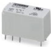
Relé de potencia en miniatura enchufable, con contacto de oro multicapa, 2 contactos conmutados, tensión de entrada 12 V DC
