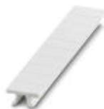
Tira Zack, Tiras, blanco, sin rotular, rotulable con: PLOTMARK, CMS-P1-PLOTTER, clase de montaje: encajar en ranura para índice alta, para ancho de borne: 5,2 mm, superficie útil: 5,1 x 10,5 mm
