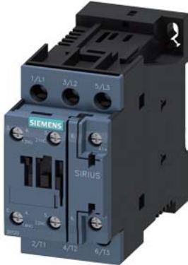
Leistungsschütz, AC-3e/AC-3, 25 A, 11 kW / 400 V, 3-polig, DC 24 V, mit eingesteckter Diodenkombination, Hilfskontakte: 1 S + 1 Ö, Schraubanschluss, Baugröße: S0
