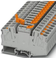
刀闸分断接线端子，标称工作电压: 1000 V，额定电流: 32 A，接线方式: 直插式连接，额定接线容量: 6 mm<sup>2</sup>，接线容量: 0.5 mm<sup>2</sup> - 10 mm<sup>2</sup>，安装: NS 35/7,5，NS 35/15，NS 32，颜色: 灰色
