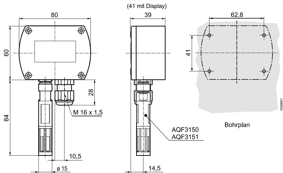
Bemessung ohne (mit) LCD-Anzeige
