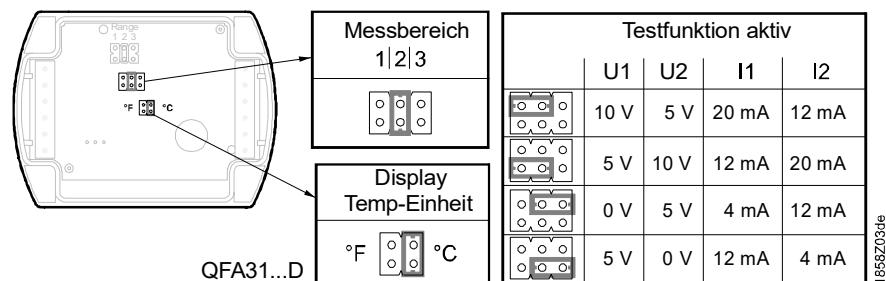
Die Einstellelemente befinden sich im Gehäusedeckel. Ein Einstellelement besteht aus 6 Kontaktstiften und einer Steckbrücke. Damit können die Einstellung des gewünschten Temperatur-Messbereichs vorgenommen und eine Testfunktion aktiviert werden. Bei Typen mit LCD-Anzeige ist ein zweites Einstellelement mit 4 Kontaktstiften und einer Steckbrücke vorhanden.
