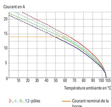
Courbe d'intensité maximale admissible : Conducteur – Conducteur
