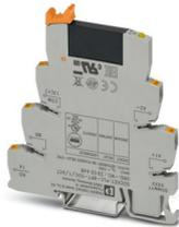
PLC-INTERFACE für Ausgabefunktionen, bestehend aus Grundklemme PLC-BPT.../ACT mit Push-in-Anschluss und steckbarem Miniatur-Solid-State-Relais, zur Montage auf Tragschiene NS 35/7,5, 1 Schließer, Eingang: 5 V DC, Ausgang: 3-33 V DC/3 A
