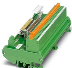
16-kanaliges Modul für Honeywell C300 Baugruppen. Das Modul wird steuerungsseitig über D-SUB 37-polig oder FLK 50-polig angesteuert. Feldseitig steht ein Schraubanschluss (1+, 1-,... 16+,16-) mit Messertrennung zur Verfügung. Modulbreite: 170 mm
