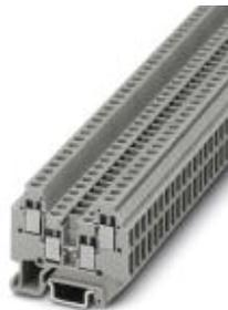
Microklemme, Querschnitt: 0,14 mm<sup>2</sup> - 1,5 mm<sup>2</sup>, AWG: 26 - 16, Anschlussart: Schraubanschluss, Breite: 4,2 mm, Farbe: grau, Montageart: NS 15
