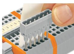
Mise en place de connecteur mâle avec outils de manipulation multiples
