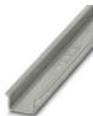
Profilé plein, Profil standard 2,3 mm, largeur: 35 mm, hauteur: 15 mm, selon EN 60715, matériau: Acier, galvanisé, traité par passivation couche épaisse, longueur: 2000 mm, coloris: argenté
