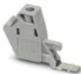
Bloc de jonction de dérivation, tension nominale: 1000 V, intensité nominale: 32 A, type de raccordement: Raccordement vissé, nombre de connexions: 1, section : 0,14 mm<sup>2</sup> - 6 mm<sup>2</sup>, AWG: 26 - 10, largeur: 8,1 mm, hauteur: 24,7 mm, coloris: gris, type de montage: sur embase
