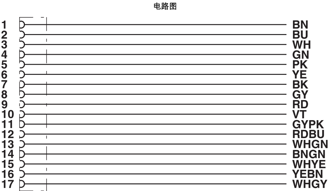
M12插座引脚分配，17芯，A编码，插座侧视图
