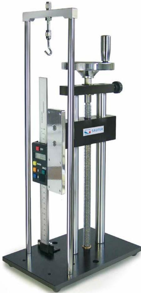
Banco di prova manuale per misurazioni della forza di trazione e di spinta ad alta precisione, con misurazione della lunghezza
