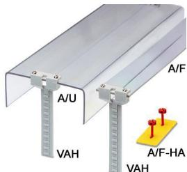
挡盖条，用于端子条的遮盖保护，厚度2 mm，宽度9 cm，还须提供2个E/UK终端固定件和2个可调节VAH盖罩支架。最大供货长度为100 cm
