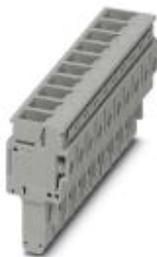
Stecker, Anschlussart: Schraubanschluss, Anzahl der Anschlüsse: 10, Polzahl: 10, Querschnitt: 0,2 mm<sup>2</sup> - 6 mm<sup>2</sup>, AWG: 24 - 8, Breite: 82 mm, Höhe: 42,7 mm, Farbe: grau
