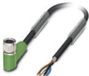
センサ/アクチュエータケーブル, 4極, PUR ハロゲンフリー, 黒-灰RAL 7021, シールド対応, 片側フリー, 上ソケット アングル M8, ケーブル長: 10 m
