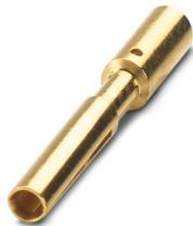
压接插针，触点直径: 1 mm，车削，孔式插头，插针材料: CuZn，触点表面: Ni/Au，接线容量: 0.34 mm<sup>2</sup> ... 1 mm<sup>2</sup>，AWG 22 ... 18
