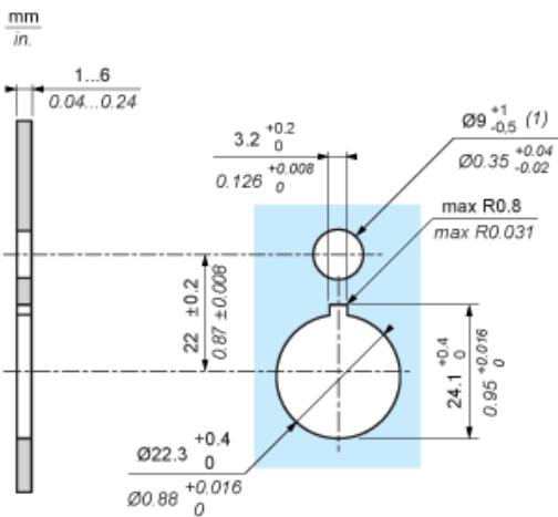
(1) : Pour les applications IP X9, la dimension max. recommandée du diamètre du trou est 9 mm/0,35 po.
