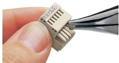
Détrompage d'un connecteur femelle – détacher la (les) tige (s) de codage.
