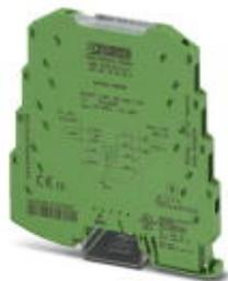
MCR 3方向絶縁信号変換器、アナログ信号を電氣的に絶縁、ネジ接続、入力信号：0~10 V/±10 V、出力信号：0~10 V/±10 V
