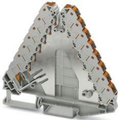
电位分配端子，具有供应至  $6 \text{ mm}^2$  的选项，标称工作电压: 250 V，额定电流: 17.5 A，接线方式: 直插式连接，额定接线容量:  $1.5 \text{ mm}^2$ ，横截面:  $0.14 \text{ mm}^2$  -  $2.5 \text{ mm}^2$ ，馈电阶段，额定接线容量:  $4 \text{ mm}^2$ ，横截面:  $0.2 \text{ mm}^2$  -  $6 \text{ mm}^2$ ，安装: NS 35/7,5，NS 35/15，颜色: 灰色，连接元件的颜色: 棕色
