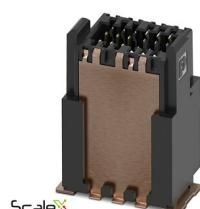
シールド対応のSMDオスコネクタ、定格電流: 1.7 A、耐電圧: 500 V AC、極数: 80、ピッチ: 0.8 mm、色: 黒、コンタクト表面: 金、コンタクトタイプ: ピン、取付け方法: SMDハンダ接続
