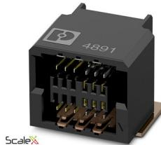
シールド対応のSMDメスコネクタ、定格電流: 1.7 A、耐電圧: 500 V AC、極数: 80、ピッチ: 0.8 mm、色: 黒、コンタクト表面: 金、コンタクトタイプ: メス、取付け方法: SMDハンダ接続
