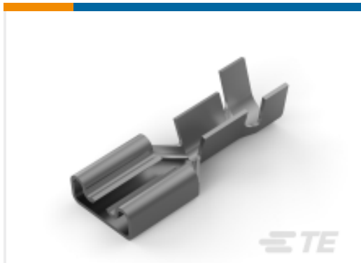
TE Part #1-100605-2 250 FASTON,REC.,14-17AWG,PTPB
