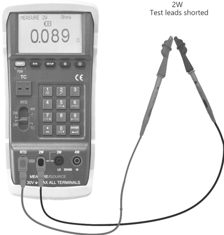
Étape 3: Appuyez sur le bouton SHIFT, puis sur le bouton DÉCALAGE (6). Un symbole delta ( $\Delta$ ) apparaît sur l'écran LCD pour indiquer que la valeur de la résistance des fils d'essai est soustraite pour les mesures ultérieures.
