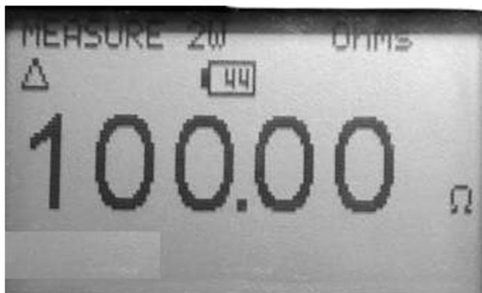
Remarque: La limite de la fonction de décalage est de 60  $\Omega$ . Si la résistance mesurée dépasse 60  $\Omega$ , un bip retentit pour alerter l'utilisateur. La fonction de décalage est alors annulée et le symbole delta  $\Delta$  n'est pas affiché sur l'écran LCD.
