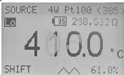
**Étape:** Appuyez d'abord sur SHIFT, puis appuyez sur le chiffre 2. Une fois la fonction ÉCHELON sélectionnée, l'icône STEP s'affiche sur l'écran LCD. Le calibrateur génère 5 niveaux de signaux (0 %, 25 %, 50 %, 75 % et 100 %) en environ 20 secondes.
