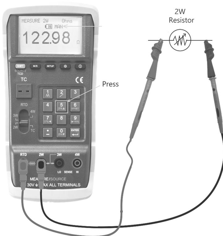
Étape 1: Suivez les étapes indiquées dans la section 3.3 et sélectionnez OHM dans la configuration. Le calibrateur génère automatiquement le courant optimal pour la mesure de la résistance. Vous pouvez également appuyer sur le bouton 5 pour accéder au mode manuel et changer le courant de sortie (100  $\mu$  A, 250  $\mu$  A, 1mA et 2mA).
