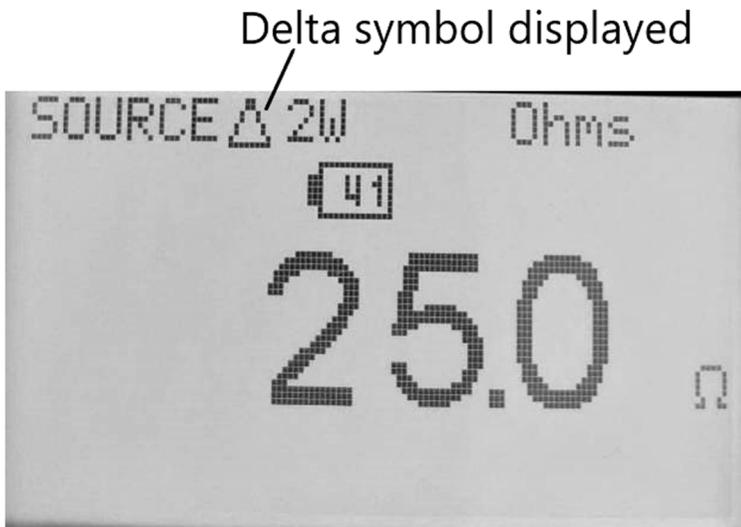
**AVERTISSEMENT:** Une fois la fonction DÉCALAGE exécutée en branchement 2 W, **NE CHANGEZ PAS** les fils d'essai utilisés ni le type ou la résistance sélectionné(e) du RTD. Si vous changez les fils d'essai utilisés ou sélectionnez un autre type de RTD ou de résistance, veuillez effectuer à nouveau les procédures de DÉCALAGE pour garantir l'exactitude en mode MESURE ou SOURCE.
