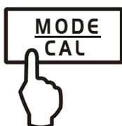
⇒ Descargar la balanza y apretar repetidamente la tecla **MODE** hasta que aparezca „PtArE“.
