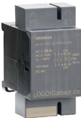
LOGO! Contact 230 开关模块，用于直接开关欧姆型用电器至 20A 及电机至 4kW，230V AC，3 个常开触点+1 个常闭 EAN:4025515050759
