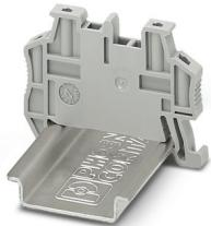
快装终端紧固件，阻燃等级V0符合UL 94标准，用于DIN导轨NS 35/7.5或NS 35/15，可用UC-TM 5、UC-TMF 5、KLM 2、KLM3和KML3L进行标记，用于安置FBS...5、FBS...6、KSS 5、KSS 6，宽度：5.15 mm，颜色：灰色
