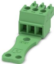
PCB插拔式连接器，额定横截面: 1.5 mm<sup>2</sup>，颜色: 绿色，额定电流: 8 A，额定电压(III/2): 160 V，触点表面: Sn，触点类型: 孔式插头，电位数: 3，行数: 1，位数: 3，连接量: 3，产品系列: MC 1,5/..-ST，针距: 3.81 mm，接线方式: 带压片的螺钉连接，螺钉头规格: L 开槽，导线/PCB连接方向: 0 °，插拔系统: COMBICON MC 1,5，互锁: 不带，安装方式: 不带，包装类型: 纸箱包装，抗外力保护装置 (STZ1)
