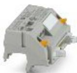
Adattatore V8 per 8 x PLC-INTERFACE (6,2 mm), controllore: Cablaggio di sistema PLC delle schede di uscita, collegamento 1: Connessione a vite 1x, collegamento 2: Connettore maschio IDC/FLK 1x 14-poli, collegamento 3: Attacco connettore (Può essere agganciato a scatto su 8 morsetti PLC-INTERFACE), numero di canali: 8, logica di comando: commutazione positiva
