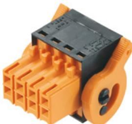
带内置横联插头，带清晰打印，在以最大的线缆横截面积连接满载流能力时，可以为电势提供不间断传输。该横联件垂直位于各排回路之间。弹片式导线联接，平直进线，间距为 3.5mm。提供法兰和释放杆。纸箱包装。
