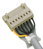
Connecteur mâle avec plaque de décharge de traction
