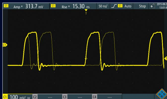
El sistema de adquisición de alta velocidad del R&S®ScopeRider captura hasta 50 000 formas de onda/s y detecta anomalías de señal poco usuales e imprevistas.
