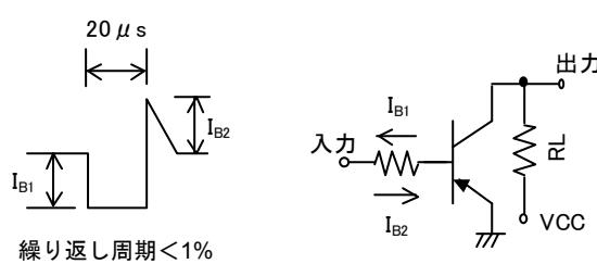
図4. スイッチング時間測定回路
