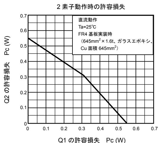
2つのトランジスタ Q1、Q2 のいずれか一方のみを単独動作させた場合の許容損失は 0.55 W Max. です。Q1、Q2 を同時に動作させた場合は、熱緩衝のために上記グラフのとおり 1 素子当たりに許容できる損失が変化しますのでご注意下さい。なお Q1、Q2 同時動作では、Q1、Q2 を同一条件で動作させた場合が、1 素子あたり 0.31 W Max. 許容でき、Q1、Q2 トータルで 0.62 W Max. となり、パッケージ効率が最も高くなります。
