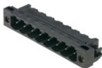
Hochtemperaturfeste Stiftleiste mit Verpackung in Box oder Tape. Im Tape mit 1,5 mm Lötstift optimiert für die Automatenbestückung. Lötstift 3,2 mm für Reflow- und Wellenlötanwendungen geeignet. Die Stiftleisten sind beschriftbar und können kodiert werden.
