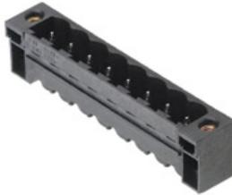
Hochtemperaturfeste Stiftleiste mit Verpackung in Box oder Tape. Im Tape mit 1,5 mm Lötstift optimiert für die Automatenbestückung. Lötstift 3,2 mm für Reflow- und Wellenlötanwendungen geeignet. Die Stiftleisten sind beschriftbar und können kodiert werden.
