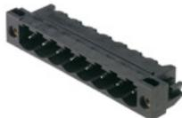
Hochtemperaturfeste Stiftleiste mit Verpackung in Box oder Tape. Im Tape mit 1,5 mm Lötstift optimiert für die Automatenbestückung. Lötstift 3,2 mm für Reflow- und Wellenlötanwendungen geeignet. Die Stiftleisten sind beschriftbar und können kodiert werden.
