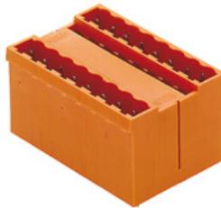
Doppelstöckige Stiftleiste mit parallelem Steckgesicht. Die Lötstiftlänge ist für Wellenlötanwendungen optimiert. Die Stiftleisten bieten Platz für Beschriftungen und können kodiert werden.
