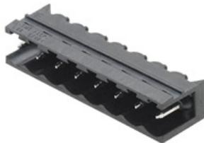
Hochtemperaturfeste, 90° abgewinkelte, offene Stiftleiste. Verpackung in Box oder Tape. Im Tape mit 1,5 mm Lötstift optimiert für die Automatenbestückung. Lötstift 3,2 mm für Reflow- und Wellenlötanwendungen geeignet. Die Stiftleisten sind beschriftbar und können kodiert werden.
