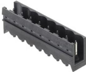
Hochtemperaturfeste, gerade, offene Stiftleiste. Verpackung in Box oder Tape. Im Tape und mit 1,5 mm Lötstift optimiert für die Automatenbestückung. Lötstift 3,2 mm für Reflow- und Wellenlötanwendungen geeignet. Die Stiftleisten sind beschriftbar und können kodiert werden.
