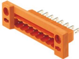
Durchführungsstiftleiste zur Frontplattenmontage mit optionaler Verriegelungsfunktion. Der interne Anschluss erfolgt als Flachsteck- oder Lötanschluss. Die Stiftleisten sind beschriftbar und können kodiert werden.
