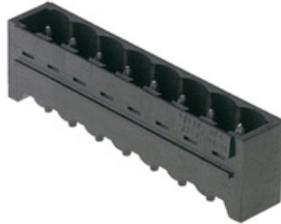
Hochtemperaturfeste Stiftleiste mit Verpackung in Box oder Tape. Im Tape mit 1,5 mm Lötstift optimiert für die Automatenbestückung. Lötstift 3,2 mm für Reflow- und Wellenlötanwendungen geeignet. Die Stiftleisten sind beschriftbar und können kodiert werden.
